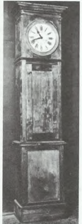
Zegar mechaniczny z 1850 r. — sterował on zegarem znajdującym się w elewacji dworca w Skierniewicach
