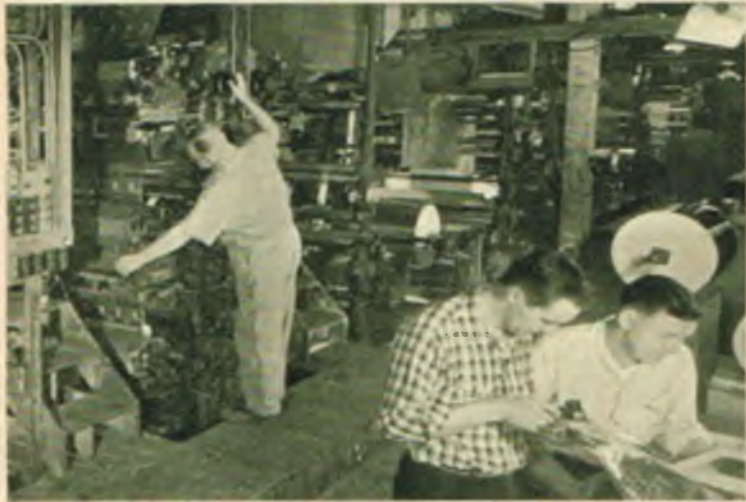
Ta maszyna rotograwiurowa drukuje w ciągu 1 godz. 25 000 egz. wielobarwnego tygodnika!
