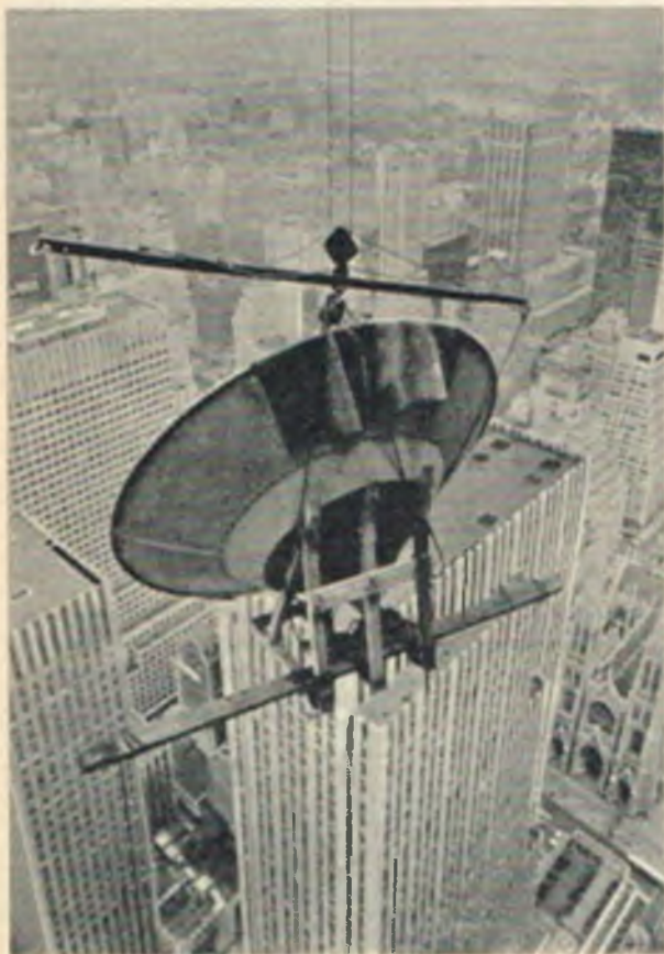
Próba dźwigu do obsługi sieci napowietrznej. Kosze s; z włókna szklanego, uniemożliwiającego porażenie prądem
