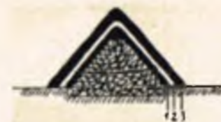
Buraki zakopcowane 1 i 3 warstwa ziemi, 2 warstwa izolacyjna.
